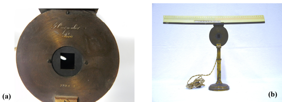
Fig. 4 Particolare del marchio Carpentier (a) e dispositivo per la lettura ottica riassemblyato (b)
