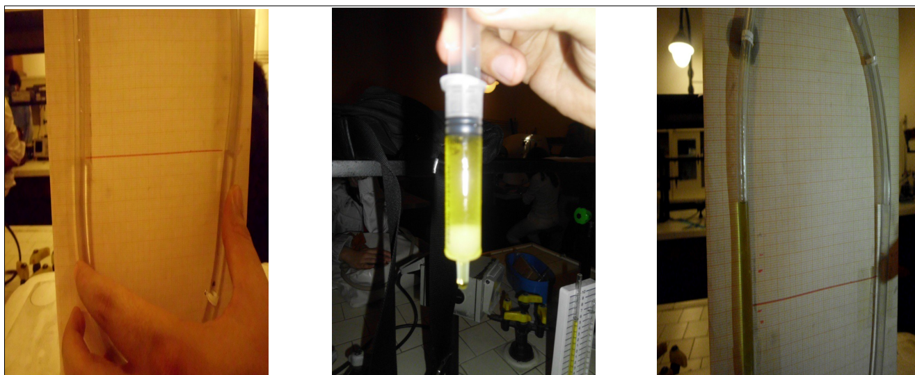
a b c Figura 3.5. Fasi dell'esperimento: Livello di riferimento (a), Dosatore di olio(b), Superfici libere dei due liquidi non miscibili (c).
