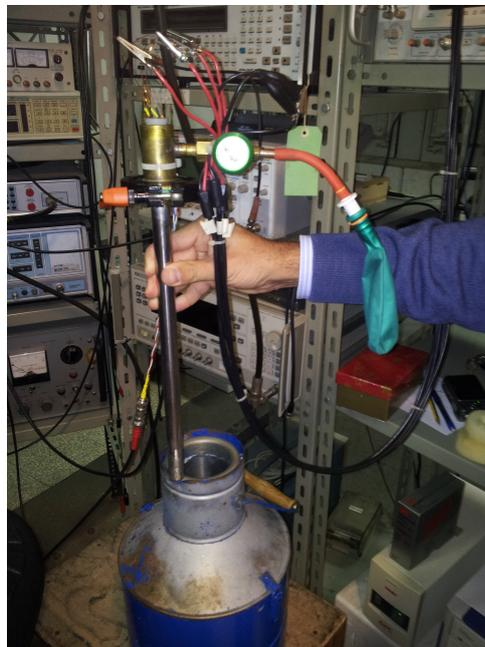
**Figura 3.2:** Foto dell'tubo di acciaio (discendente) contenente il campione e il termoresistore.
