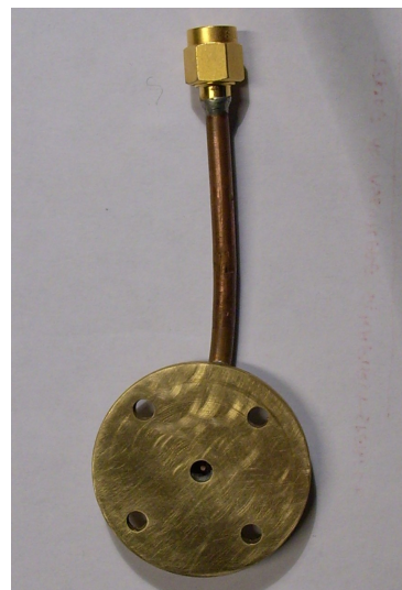
Figura 6.2: A sinistra: Vista in prospettiva del cilindro di \text{MgB}_2 , parte integrante della cavità coassiale. Nell'immagine si possono vedere i due anelli di ottone saldati su un sottile strato di rame e usati per fissare i connettori SMA alla cavità. A destra: Uno dei due adattatori opportunamente realizzati per poter alimentare la cavità con accoppiamenti di tipo capacitivo.
