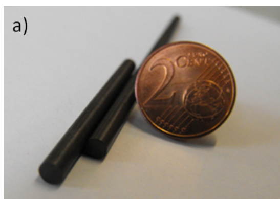
Figura 6.3: a) Vista in prospettiva delle due bacchette di \text{MgB}_2 usate come conduttore interno delle cavità coassiali. b) Vista dall'alto del cilindro di rame placcato in oro usato per la cavità ibrida lunga.
