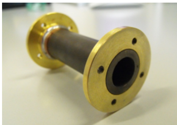
Figura 6.2: A sinistra: Vista in prospettiva del cilindro di \text{MgB}_2 , parte integrante della cavità coassiale. Nell'immagine si possono vedere i due anelli di ottone saldati su un sottile strato di rame e usati per fissare i connettori SMA alla cavità. A destra: Uno dei due adattatori opportunamente realizzati per poter alimentare la cavità con accoppiamenti di tipo capacitivo.
