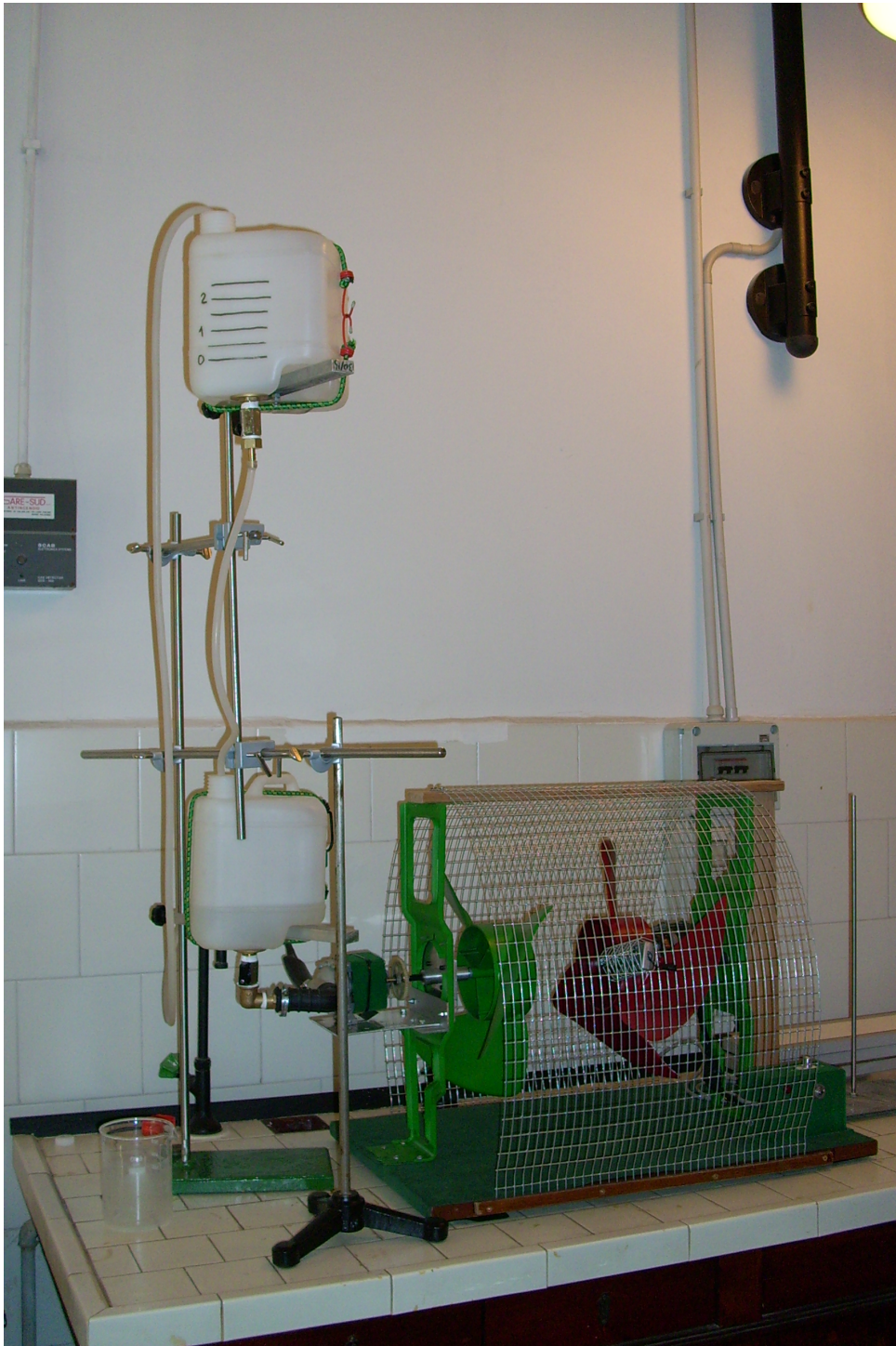
Figura 2.1: Fotografia dell'apparato sperimentale usato. Nella foto è facilmente visibile il contenitore graduato per la misurazione della massa di acqua pompata da un livello più basso ad un livello più alto.
