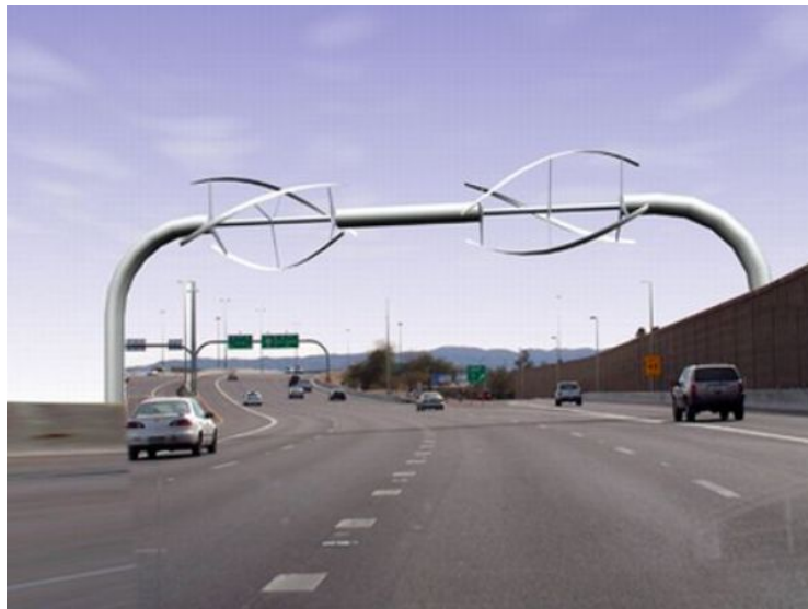
Figura 1.3: Turbina in grado di produrre 9.6 kWh di energia annua sfruttando il movimento dell'aria generato dal passaggio di veicoli. Immagine adattata da [3].
