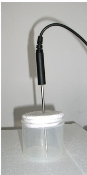
**Figura 2.5:** Disposizione del sensore di temperatura nel recipiente per la rilevazione della temperatura dell'acqua.
