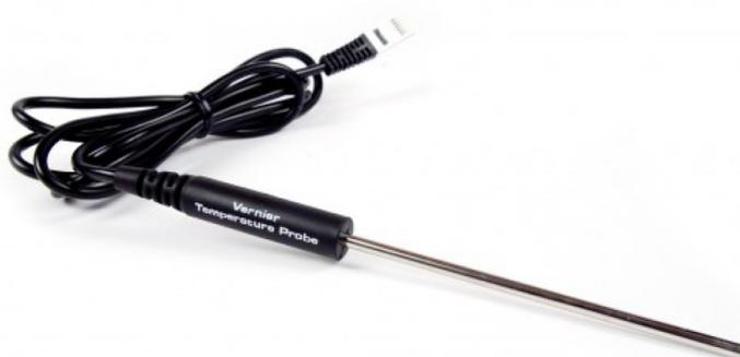
Figura 2.4: Sensore di temperatura. Immagine adattata da [7].
