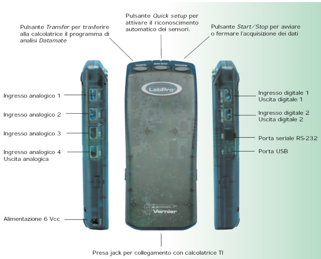
Figura 2.4: Immagine dell'interfaccia Vernier LabPro per la connessione del sensore di pressione al computer.
