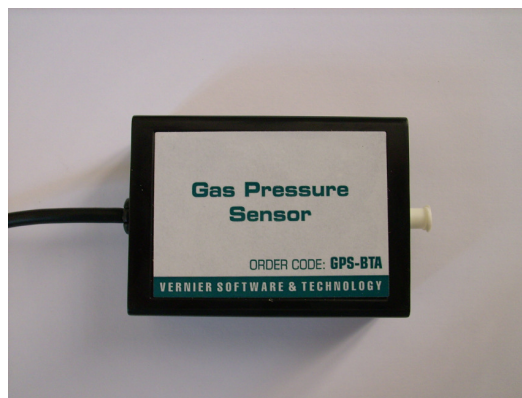
Figura 2.3: Immagine del sensore di pressione. Sul lato destro si può vedere la bocca per la rilevazione della pressione dei gas.
