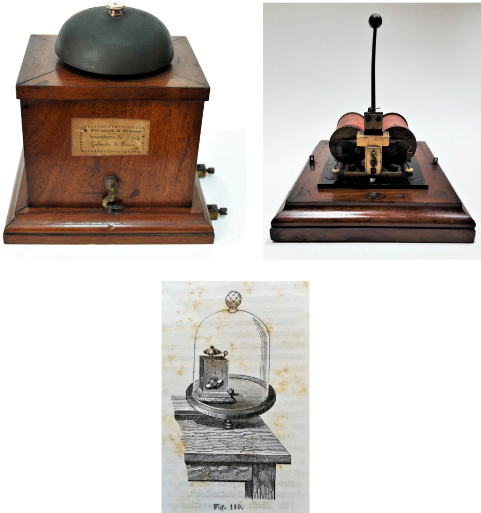
Figura 1.11: Campanello elettrico e circuito interno, dispositivo elettromeccanico utilizzato per generare un suono percuotendo ripetutamente una campana in bronzo [1].
