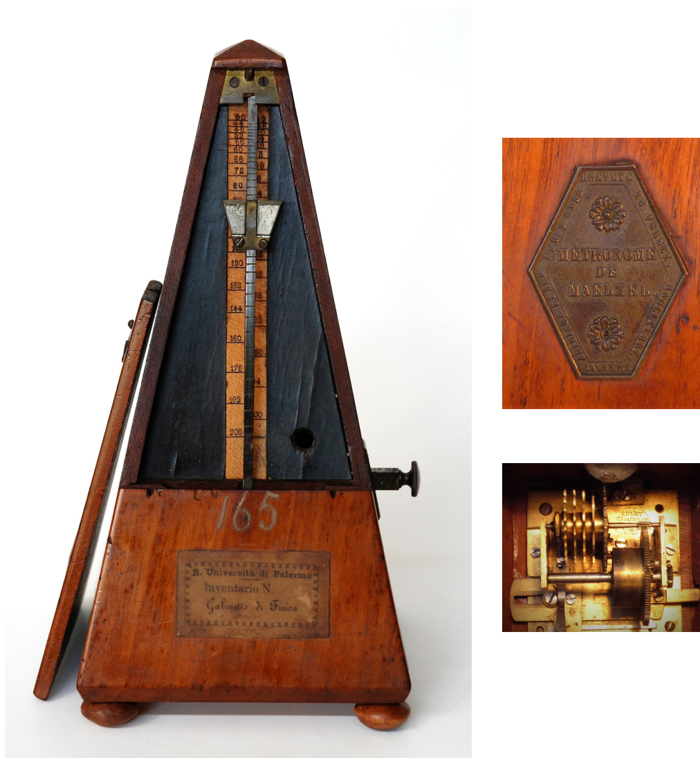
Figura 1.20: Metronomo di Maelzel con dettaglio della targhetta e del meccanismo interno.
