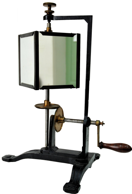
Figura 1.9: Specchi rotanti per l'apparecchio a fiamme manometriche di Koenig [1,2].
