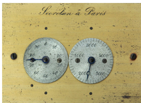
Figura 1.17: Sirena di Cagniard de La Tour per la misura della frequenza assoluta dei suoni [1,2]
