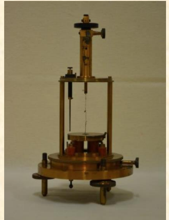
Elettrometro di Dolezalek 1900 ca
